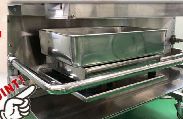
POINT! 台秤は各計量ポジションへ自動で移動します!
