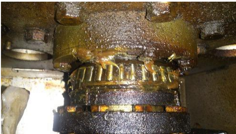
【参考：破損したベアリング】
