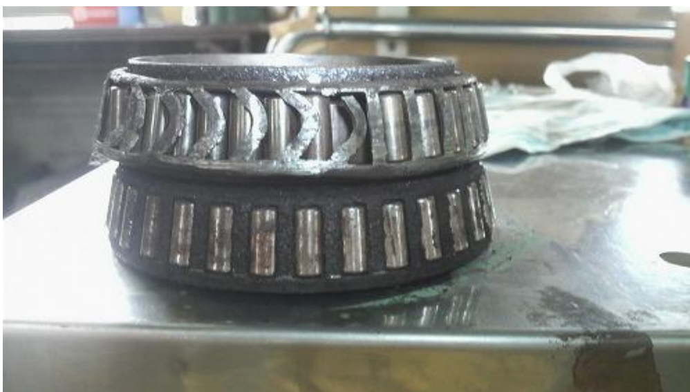
【参考：破損したベアリング】
